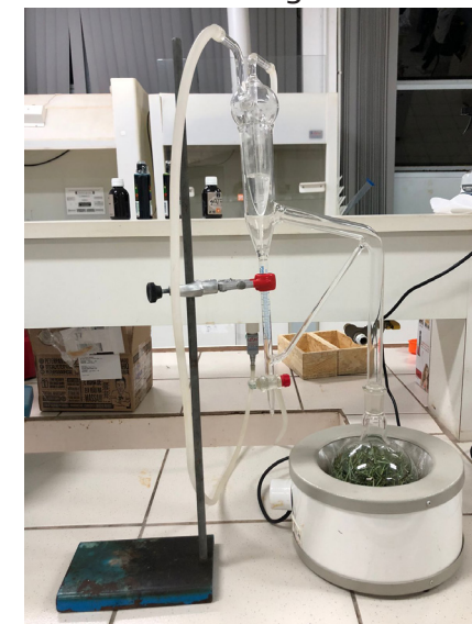
Figura 4 – Realização da extração do óleo essencial de alecrim por hidrodestilação no aparelho de Clevenger.
