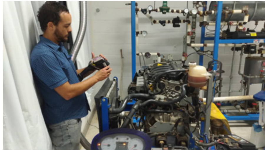
Figura 9 – Estudante realizando o monitoramento da temperatura do bloco do motor.
