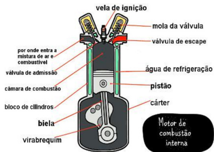
Figura 3 - Partes internas do motor a combustão via ciclo de Otto.
