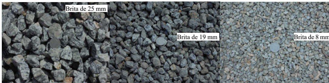
Figura 9 – O produto final de acordo com a sua granulometria e o pó de brita , pronto para o venda e consumo.
