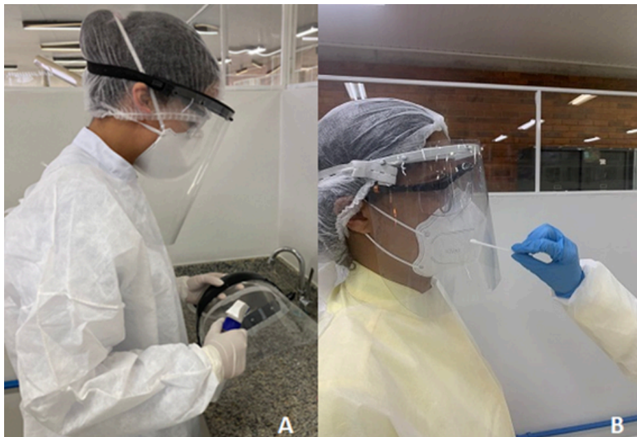
Figura 1- a. Desinfecção prévia dos PFs com álcool 70%; b. Coleta na superfície dos protetores faciais após exposição do aerossol.
